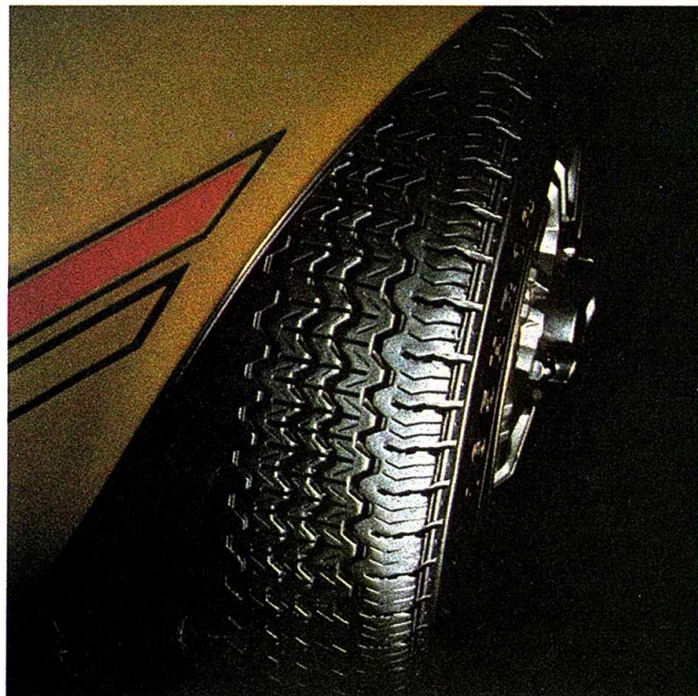
タイヤは偏平、6.45H-13-4PR。(写真はオプションのラジアル)
