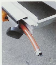
Tubo per lo scarico delle acqua posto all'interno del paraurti.
