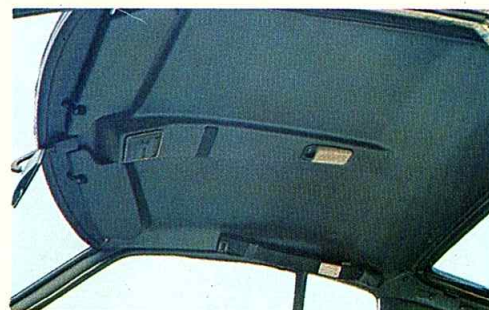
ヘッドクリアランスを確保した成型天井
